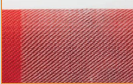
**Feuerlöschschlauch nach DIN 14811 mit roter Außenbeschichtung aus Polyurethan**
