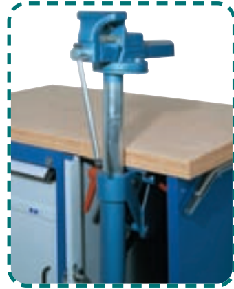
Der höhenverstellbare, dreh- und kippbare Schraubstock mit 115 mm Backenbreite verschwindet bei Nichtbedarf in der Werkbank.
