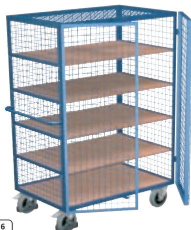
6 Geschweißte Winkelstahlkonstruktion mit Rohrschiebegriff Drahtgitter 50×50×4 mm 1 fester und 4 lose Böden, Doppelflügeltür mit Treibriegelverschluss und Zylinderschloss Etagenabstand: 280 mm, Tragkraft pro Einlegeboden: 80 kg
