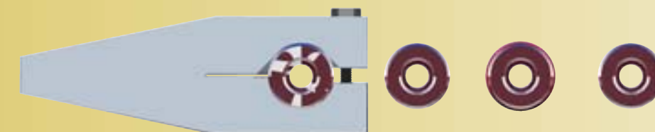
Wiederaufbau der Wellenoberfläche für eine Klemmverbindung
