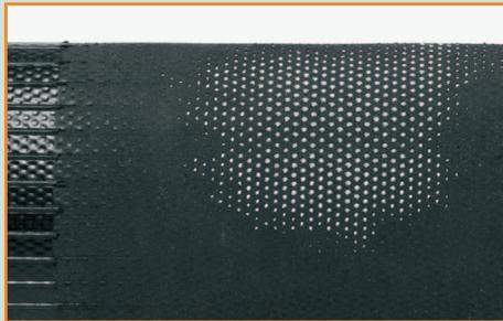
**FORMAT Mehrzweckschlauch (nach 300 Zyklen)**
