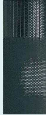
FORMAT Mehrzweckschlauch (nach 300 Zyklen): Die Rippen sind abgeschürft, das Gewebe ist an einzelnen Stellen sichtbar.
