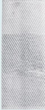
Bau- und Industrieschlauch (nach 80 Zyklen): Das Gewebe ist durchgescheuert, und der Schlauch ist undicht.
