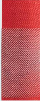
Feuerlöschschlauch nach DIN 14811 mit roter Außenbeschichtung aus Polyurethan (nach 250 Zyklen): Ein deutlich besseres, jedoch nicht zufriedenstellendes Ergebnis. Das Gewebe ist angerissen.
