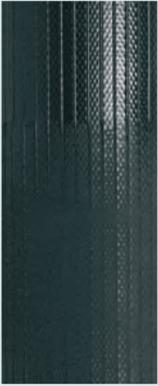
FORMAT Mehrzweckschlauch (nach 100 Zyklen): Leichte Abschürfungen an den Gummirippen. Das Gewebe (Druckträger) ist noch immer sicher im Gummi eingebettet.
